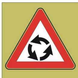
L9 - Panou presemnalizare Intersecției cu sens Giratoriu
