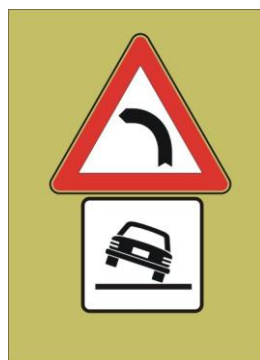
L11 - Panou curbă la stânga + pericol de răsturnare
